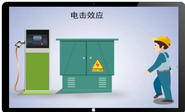
电流低于导通极限值时，会有相应的电击效应，从而容易因肢体不受控制和失去平衡而导致受伤。
